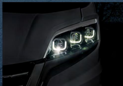
Optimale Leuchtkraft und Sichtverhältnisse, geringer Energieverbrauch und enorme Langlebigkeit. Die Frontscheinwerfer mit Abblend-, Fern- und Tagfahrlicht in Voll-LED-Technologie überzeugen auf ganzer Linie, auch im Design (baureihenübergreifend).
