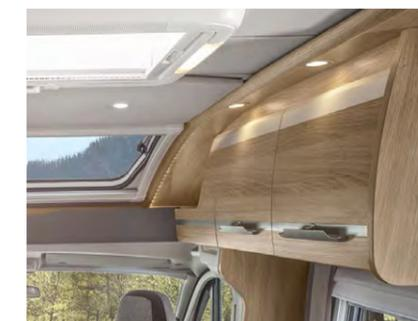
**Deckenschränke.** Sie werden besonders stabil konstruiert und mit Abstand zu den Wänden montiert. So wird Kondenswasserbildung in den Schränken verhindert und Ihre Kleidung und Waren bleiben immer angenehm trocken und frisch.
