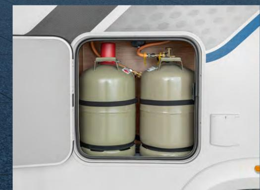
Modellabhängig ist ein längsangeordneter Gaskasten für zwei 11 kg Gasflaschen verbaut. Dort finden beide Gasflaschen nebeneinander Platz und können so besonders leicht gewechselt werden. In Kombination mit dem sehr einfach austauschbaren, optionalen Gasfiltereinsatz werden die gesamte Gasanlage sowie alle gasbetriebenen Geräte effektiv geschützt.
