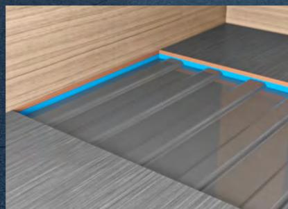
Die auf die Karosserieform perfekt angepasste Bodenplatte fertigen wir in Sandwich-Bauweise. Dadurch erhalten unsere Camper Vans neben zusätzlichem Isolationseffekt auch eine maximierte Stehhöhe im Innenraum. In der Dinette verbauen wir zudem einen Zwischenboden, der dank Temperierung für angenehm warme Füße sorgt (modellabhängig/baureihenübergreifend).
